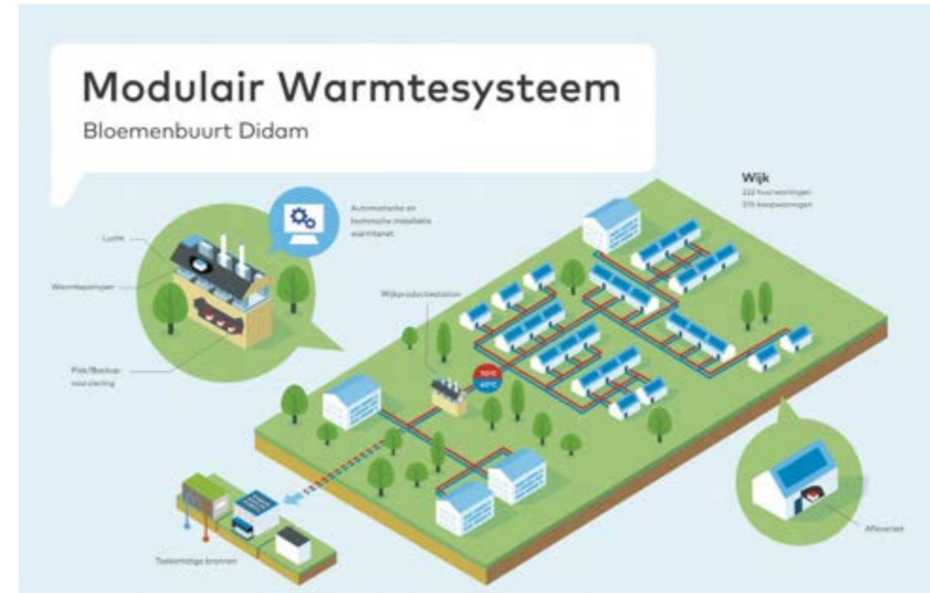
Figuur 3. Illustratie van een buurtwarmtenet - gebaseerd op het modulaire warmtesysteem in de Bloemenbuurt in Didam (bron: Stichting Warmtenetwerk/Firan)
